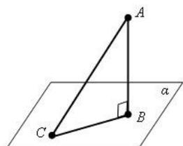
5. **Теорема о трех перпендикулярах.** Если прямая, проведенная на плоскости через основание наклонной, перпендикулярна её проекции, то она перпендикулярна к наклонной.
